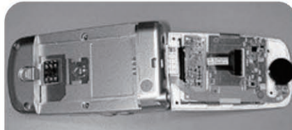
软性电路板于折叠式手机的应用(照片来源： www.careergroups.com/)
