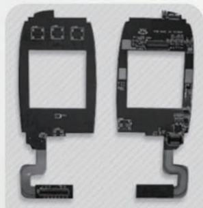
手机内软硬版结合应用 (照片来源： www.yeuhwan.com.tw )
