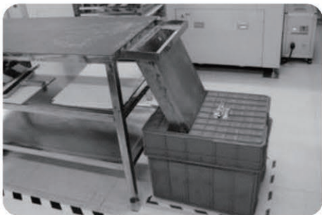
划裂工序下料口进行封盖减少粉尘扩散
